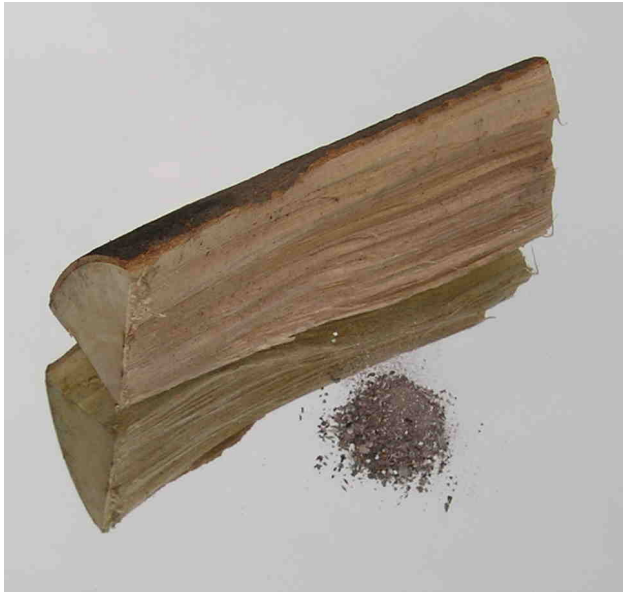
Foto: een rest van circa 5 gram minerale as blijft over na volledige verbranding van circa 500 gram luchtdroog beukenhout (20% vocht)
